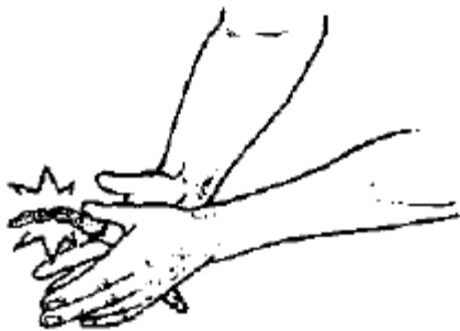
Figura 3. Prueba “Cinta de barro”
