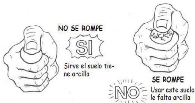
Figura 5. Prueba “Presencia de arcilla”
