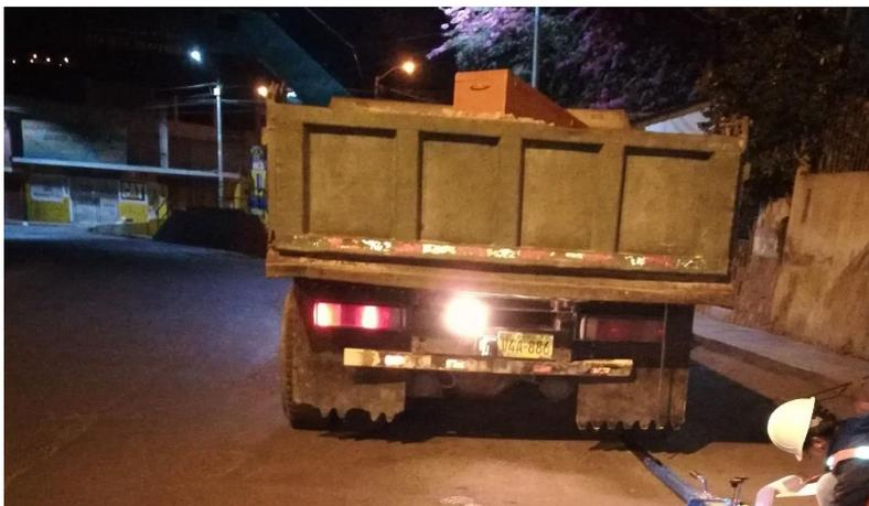
*Figura 26. Vehículo de carga para ensayo de viga Benkelman*
