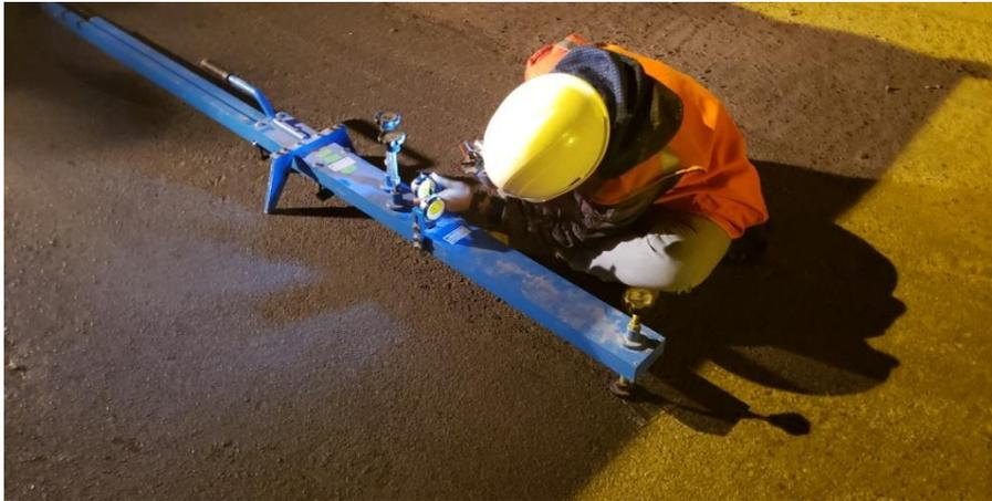
*Figura 25. Empleo de la viga Benkelman*
