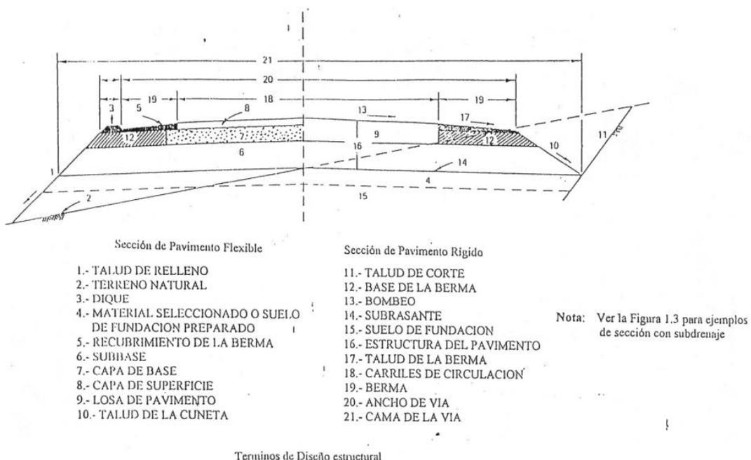
Figura 2. Sección típica de estructuras de pavimento flexible o rígido
