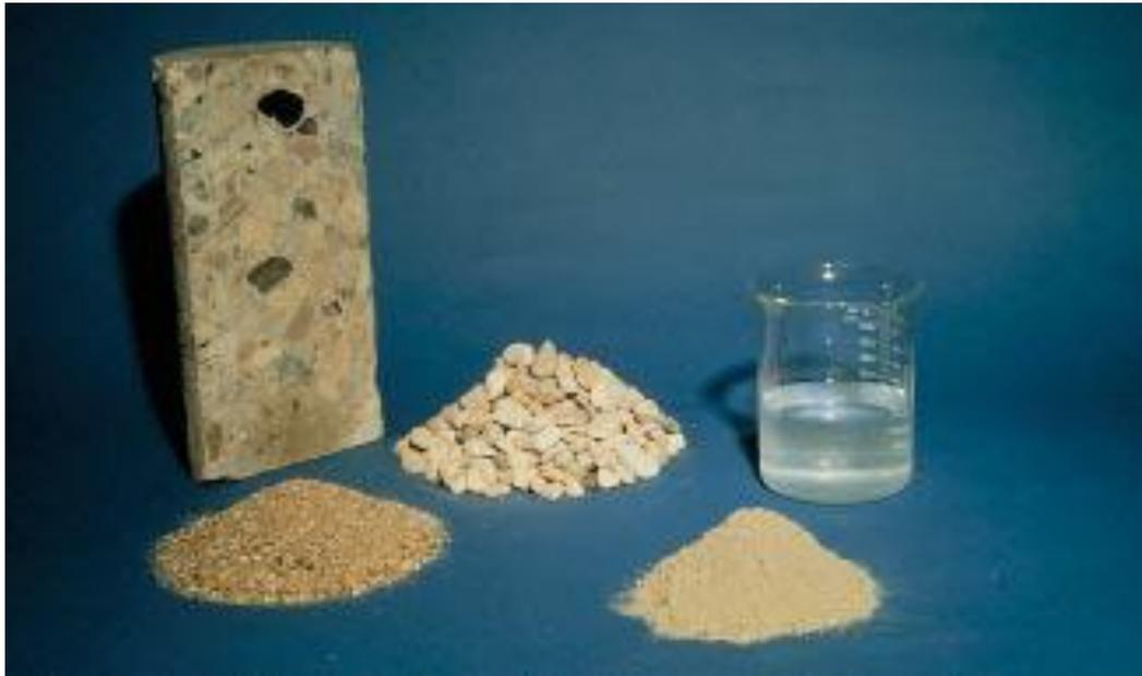
*Figura 1.* Componentes del concreto: cemento, agua, agregado fino y agregado grueso.
