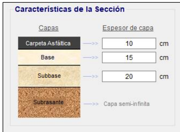
Figura 80 Estructura Final del Pavimento (Tramo III)
