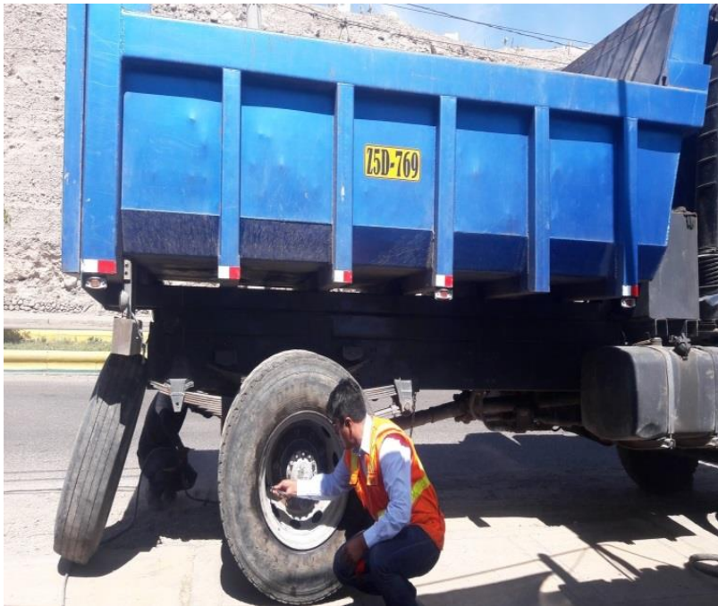
Figura 57. Medida de presión de aire al neumático.
