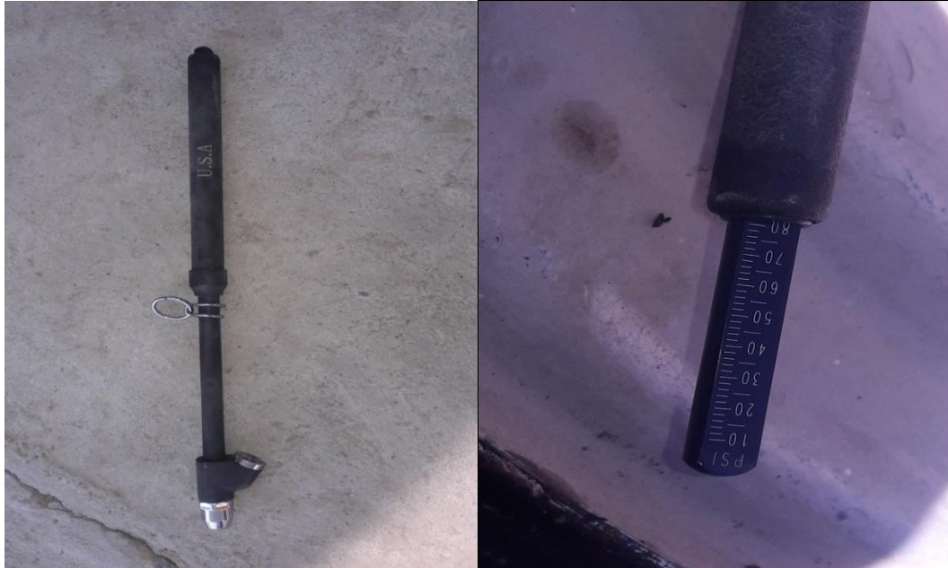
Figura 58. Medidor de presión
