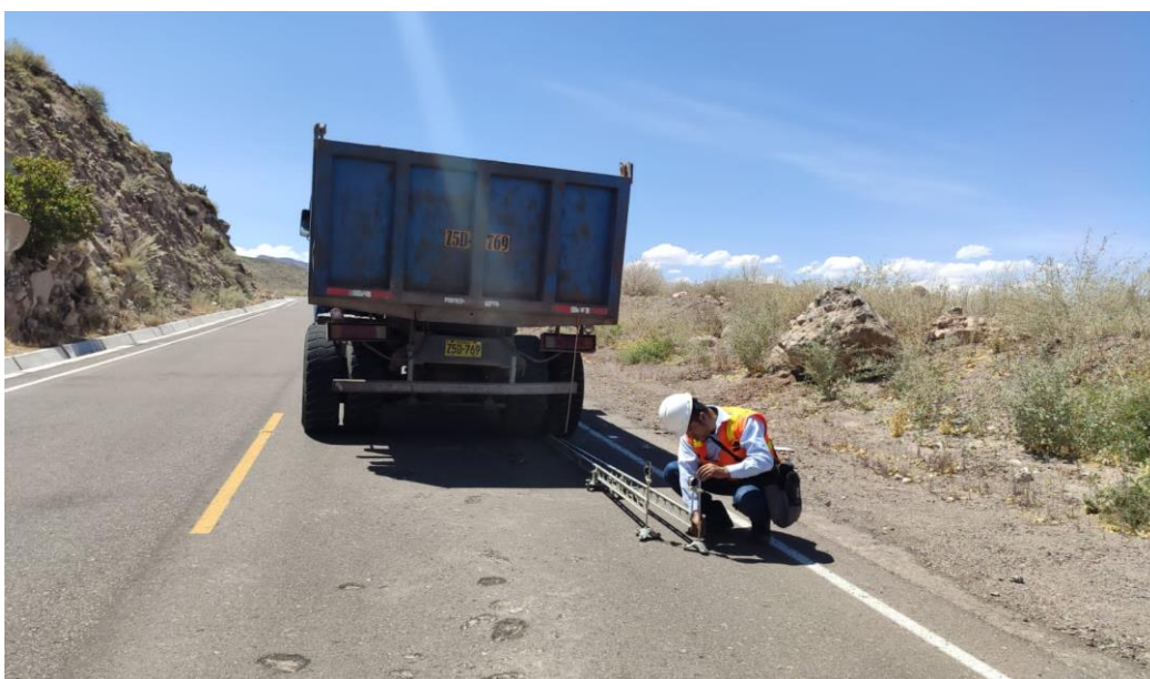
Figura 9. Procedimiento en campo de uso del equipo Viga Benkelman (Carril derecho)
