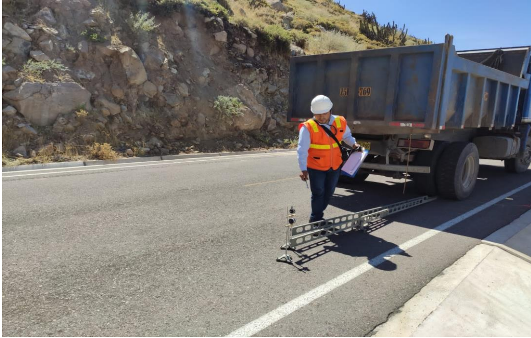
Figura 10. Procedimiento de toma de datos (lectura deflectometría)
