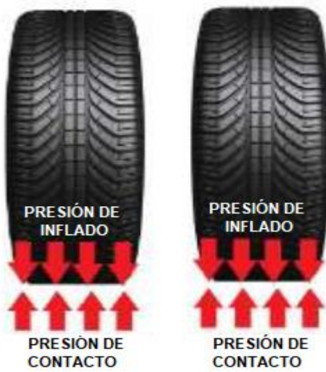
Figura 21. Presión de contacto, presión de inflado de los neumáticos Fuente: Instituto Mexicano de Transporte, 2018
