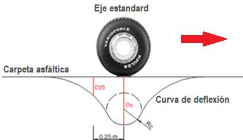
Figura 19. Deformada del pavimento y radio de curvatura
