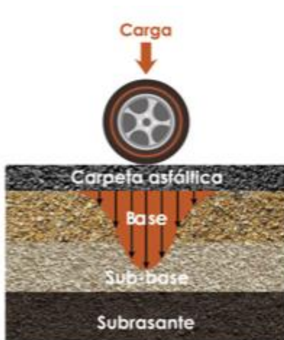
Figura 25. Cargas distribuidas del pavimento flexible
