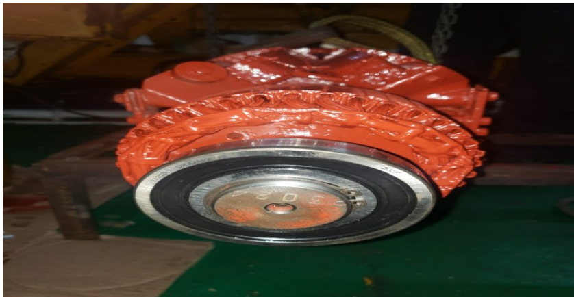
Figura 41. Rodaje nuevo del rotor del generador Caterpillar Modelo 3304
