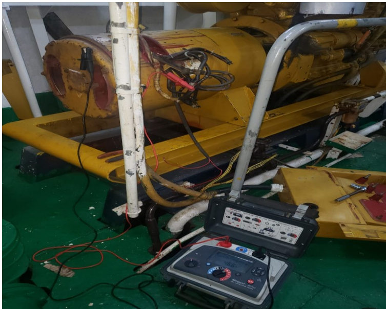
Figura 42. Megado de la bobina del estator del generador Caterpillar Modelo 3304
