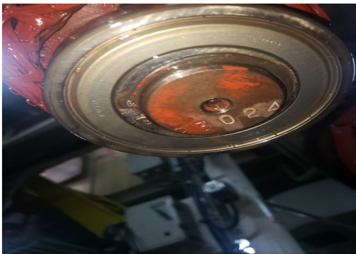
Figura 37. Rodaje del eje del rotor del generador Caterpillar Modelo 3304
