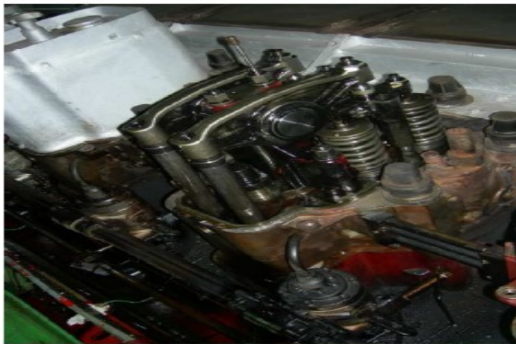
Figura 46. Calibración de válvulas de admisión y escape
