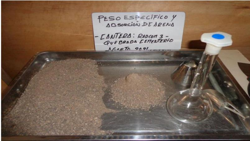
Figura 49. CR3 – Peso específico y absorción de la arena
