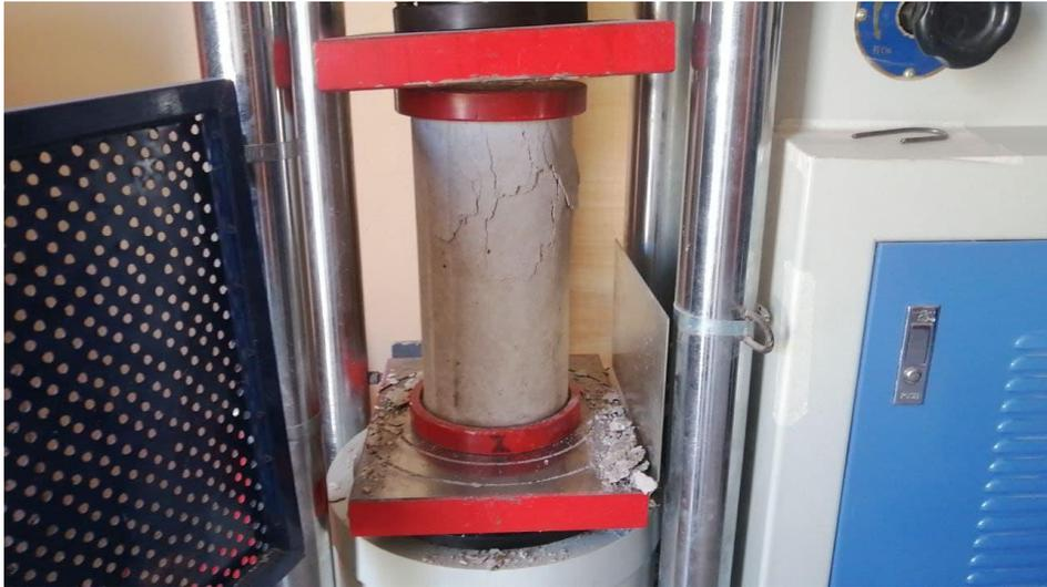
*Figura 61.* Tipo de falla de la quinta probeta ensayada
