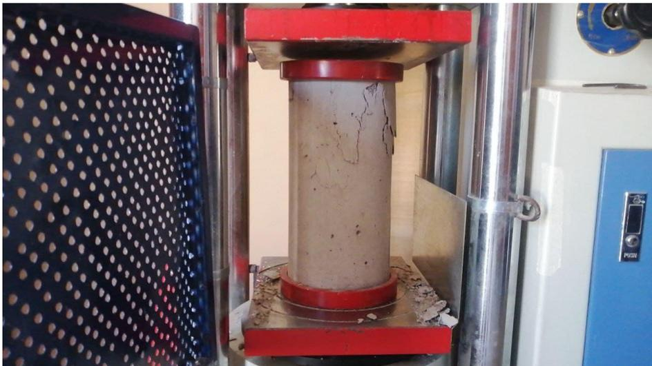
*Figura 60.* Tipo de falla de la cuarta probeta ensayada
