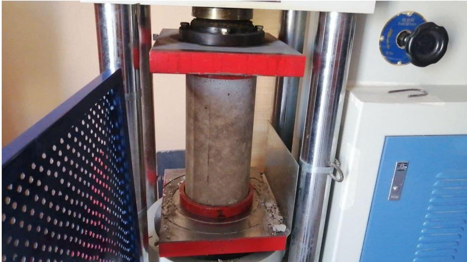
*Figura 55.* Inserción de la probeta en los discos de soporte
