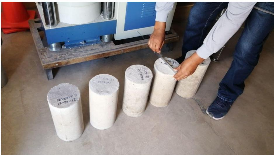
*Figura 54.* Registro de dimensiones de la probeta
