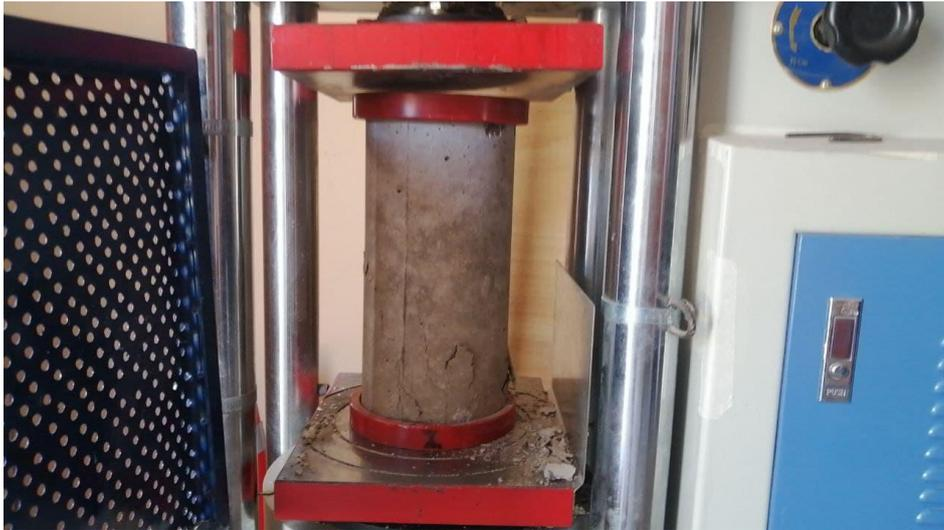
*Figura 57.* Tipo de falla de la primera probeta ensayada
