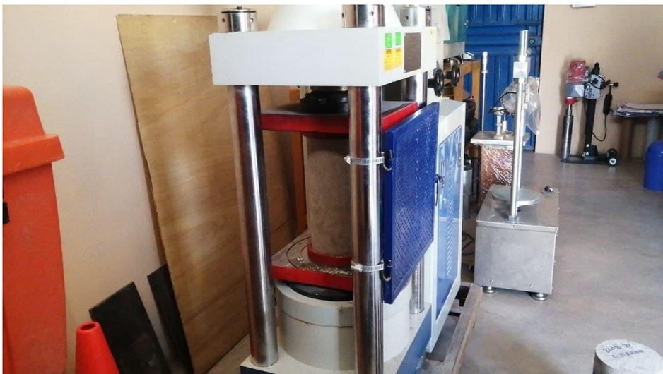
*Figura 56.* Maquina especializada para ensayo de resistencia
