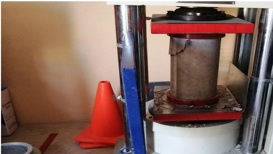
*Figura 58.* Tipo de falla de la segunda probeta ensayada
