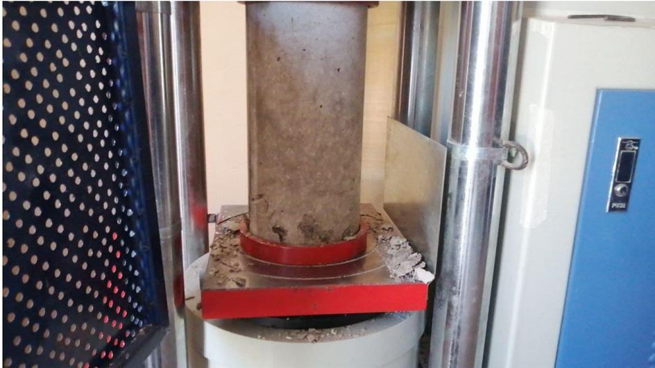
*Figura 59.* Tipo de falla de la tercera probeta ensayada
