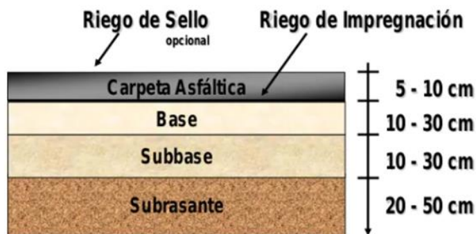
Figura 2. Sección transversal de un pavimento flexible
