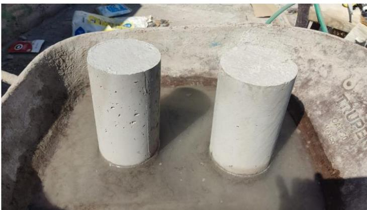
Para morteros de juntas de mampostería sin aditivo permeabilizante de igual forma se aprecia considerable ascenso y absorción de humedad por capilaridad. fig. 31
