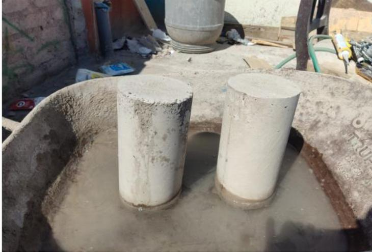
Para el mismo diseño de concreto con aditivo Sika 1 con una dosificación de 1.8 lts. Por bolsa de cemento; es notorio y resaltante que el porcentaje de absorción no progresa debido a que el aditivo incorporado, satura los micro vacíos del concreto convirtiéndolo resistente a la humedad con impermeabilidad al 100%. Ver fig. 30
