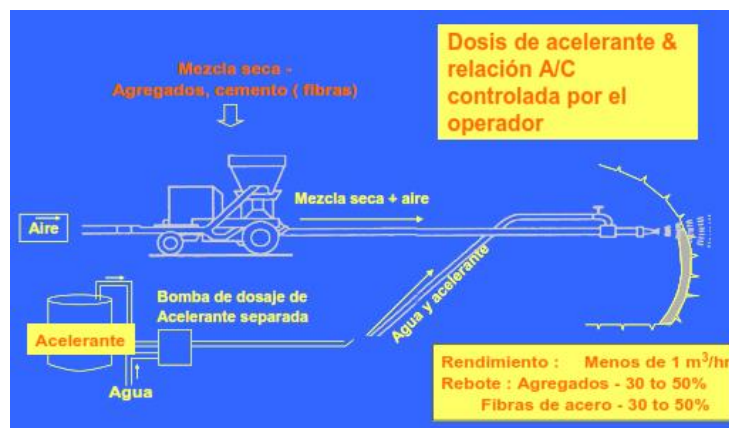
Figura 56. Equipo de lanzamiento de concreto vía seca. Fuente: Zúñiga, 2008.
