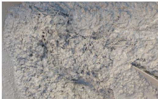
Figura 88. Concreto F'c = 210 \text{ kg/cm}^2 + 6 \text{ kg de fibra}
