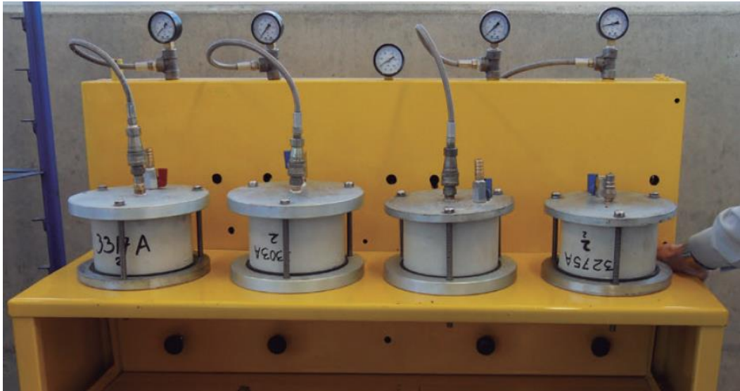
Figura 12. Dispositivo de medición de la permeabilidad del concreto Fuente: Sika mexicana, 2013
