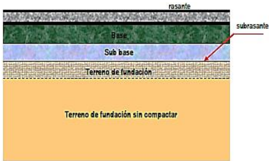
Figura 2. Estructura típica de pavimentos asfálticos
