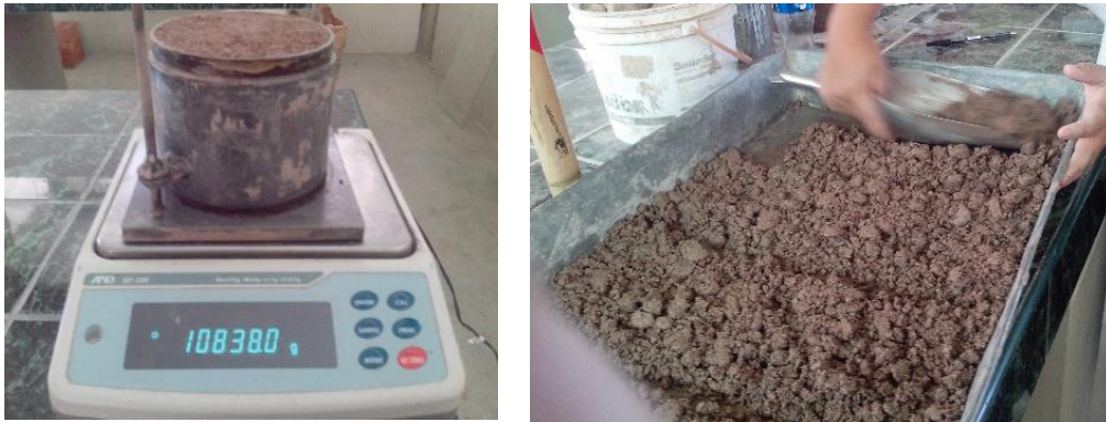
Figura 24. Realización del ensayo proctor modificado de la C-1
