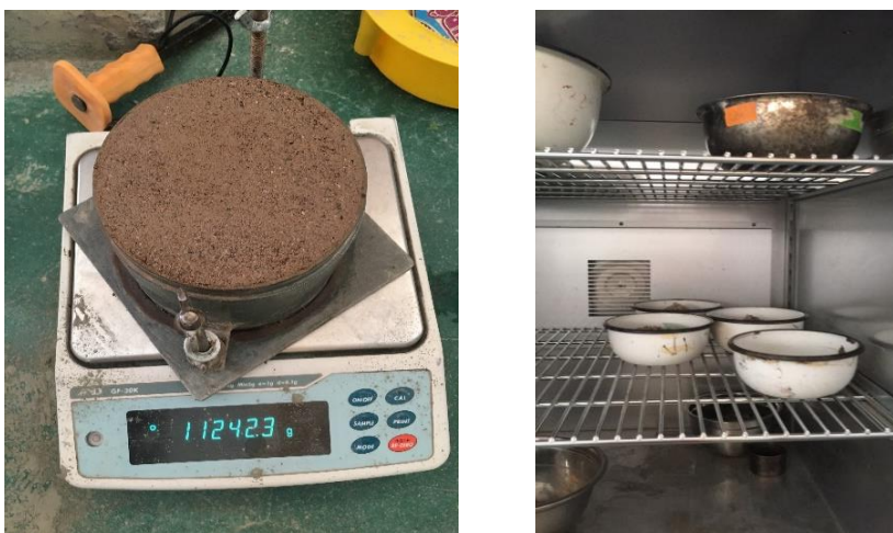
Figura 26. Realización del ensayo proctor modificado de la C-3
