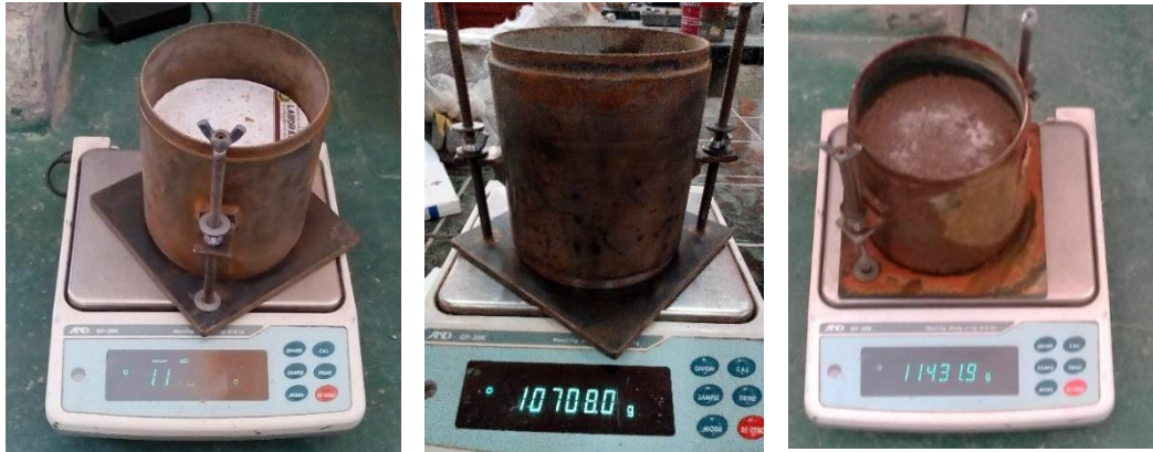
Figura 27. Realización del ensayo de CBR
