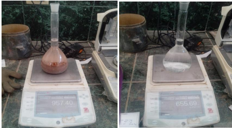
Figura 22. Realización del ensayo estándar para la gravedad específica de sólidos de suelo mediante picnómetro de agua
