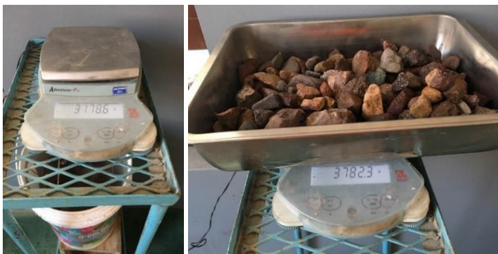
Figura 21. Realización del ensayo del peso específico y absorción del agregado grueso.
