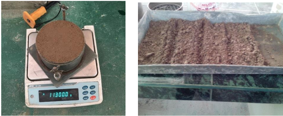
Figura 25. Realización del ensayo proctor modificado de la C-2
