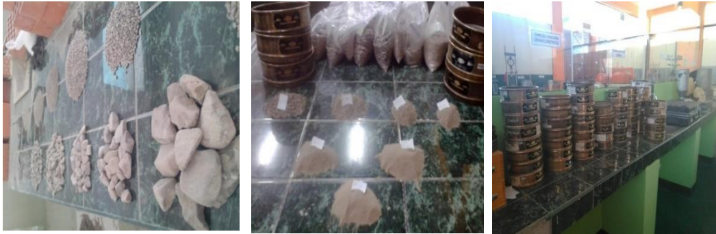
Figura 17. Tamices utilizados y material ya separados en el ensayo de análisis granulométrico
