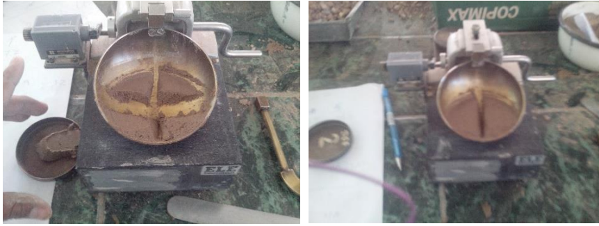
Figura 19. Realización del ensayo para determinar el límite líquido
