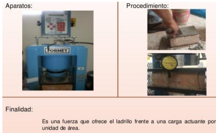
Figura 5. Resistencia a la compresión – NTP 399.604
