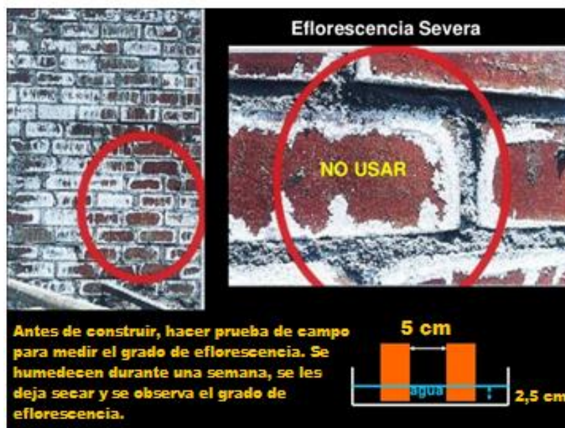
Figura 9. Grado de eflorescencia
