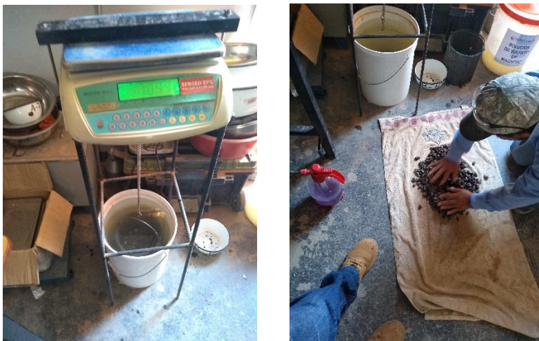
Figura 20. Procedimiento de ensayo de peso específico en agregado grueso
