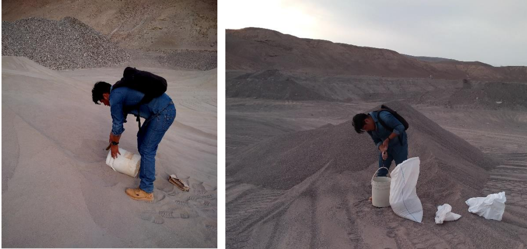
Figura 2. Toma de muestras de agregado fino (arena para asfalto), cantera Las Congas
