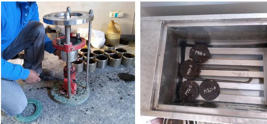
Figura 31. Extracción de especímenes y colocación en baño de maría por cuatro días
