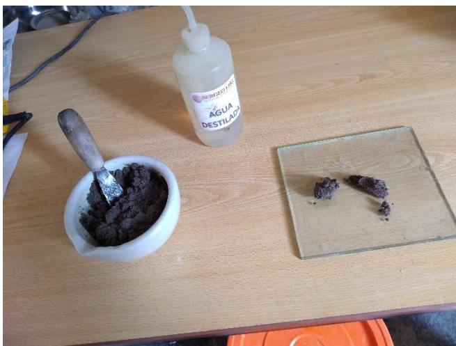
Figura 16. Resultado de intento de ensayo de límite plástico (pasante de malla N° 40)
