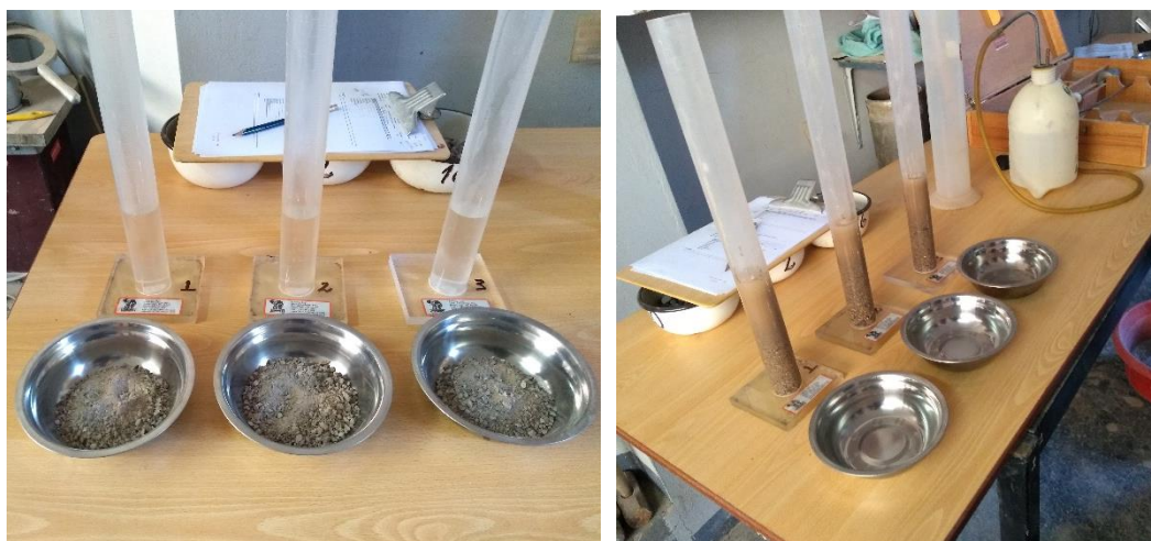
Figura 13. Muestras para ensayo de equivalente de arena
