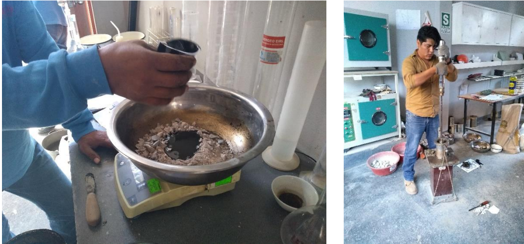
Figura 30. Preparación de mezcla y compactación con martillo Marshall
