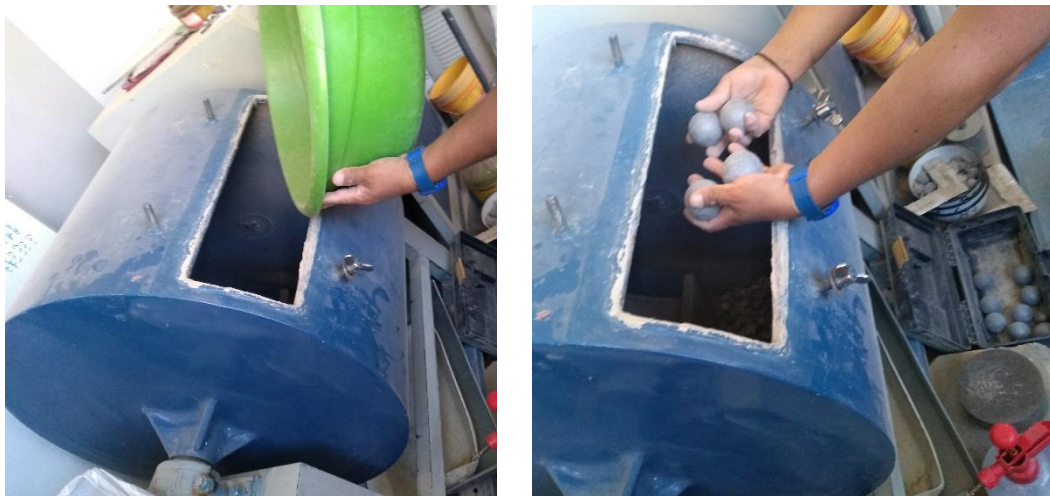
Figura 10. Colocación de muestra de agregado grueso y esferas de acero en máquina Los Ángeles
