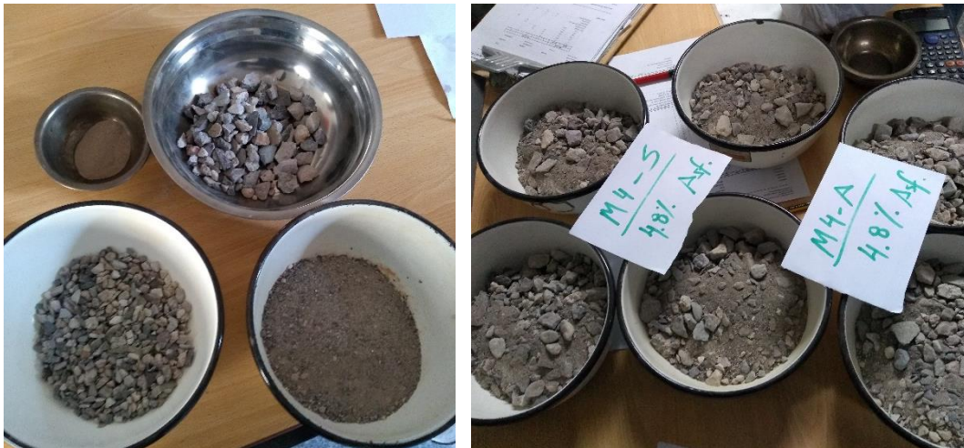
Figura 29. Pesado de agregados para fabricación de especímenes según porcentajes de asfalto
