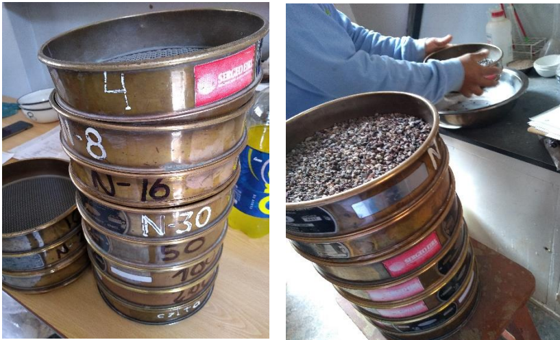
Figura 7. Tamices para análisis granulométrico del agregado fino (arena para asfalto)
