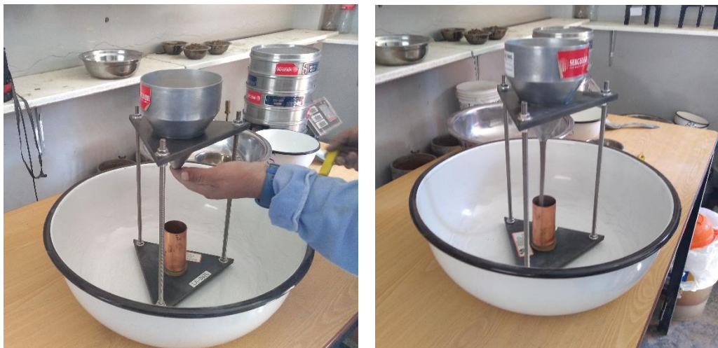
Figura 14. Equipos para ensayo de angularidad del agregado fino
