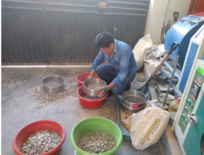
Figura 6. Proceso de tamizado del agregado grueso (piedra chancada de 3/4")
