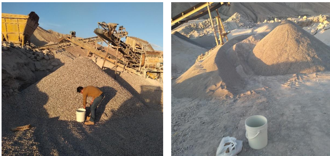
Figura 1. Toma de muestras de agregado grueso y fino para ensayos, cantera Anita II
