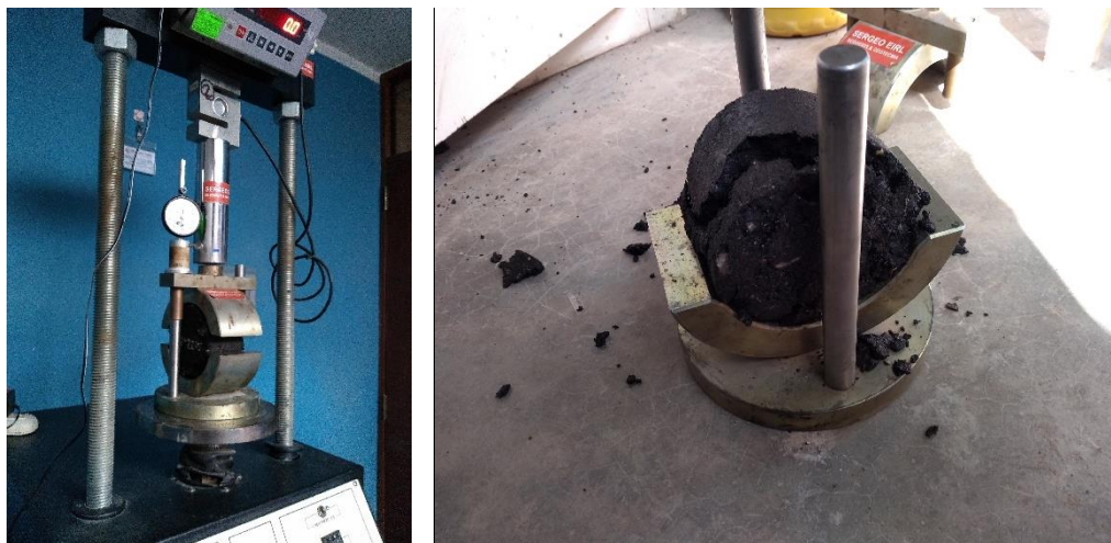
Figura 33. Prensa Marshall para medición de estabilidad y flujo de especímenes compactados
