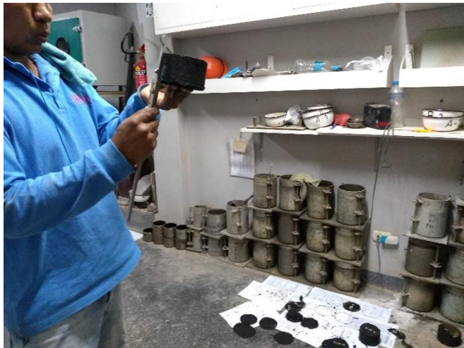
Figura 32. Medición de espesor o altura de especímenes
