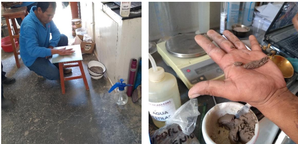
Figura 18. Intento de ensayo de límite plástico (pasante de malla N° 200)
