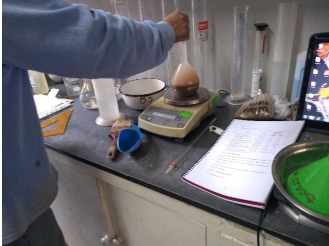
Figura 22. Pesado de fiola + filler + agua para ensayo de peso específico en agregado fino
