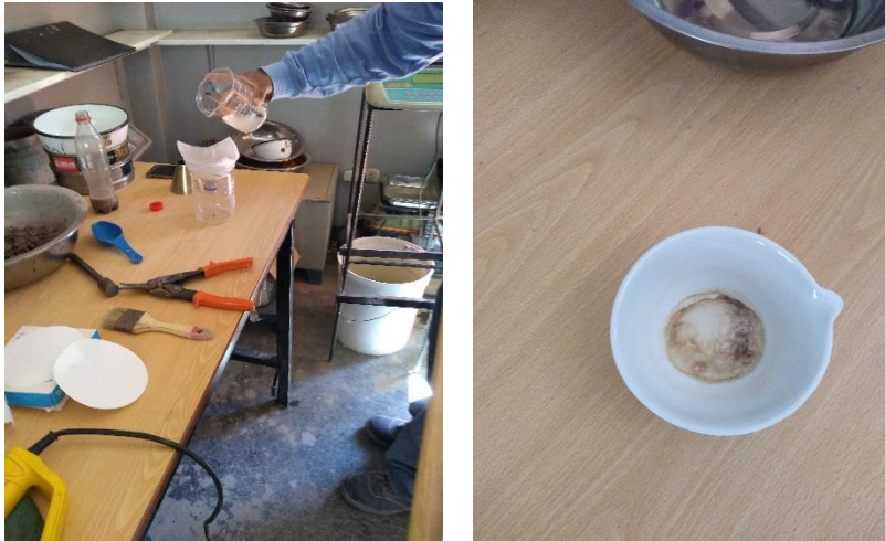
Figura 19. Procedimiento de ensayo de sales solubles
