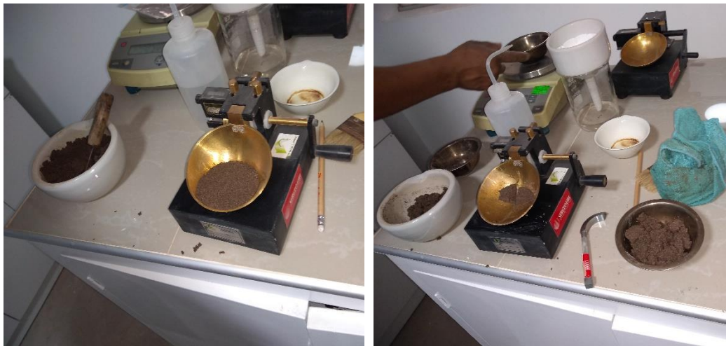
Figura 15. Ensayo de límite líquido del agregado fino (pasante de malla N° 40)
