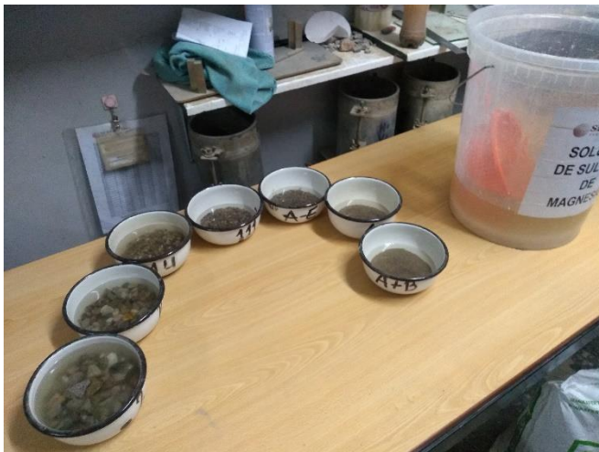
Figura 9. Muestras de agregado grueso y fino sumergidas con solución de sulfato de magnesio
